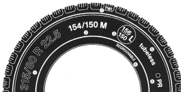
Şəkil 2. Şinin üzərindəki şərti işarələr
