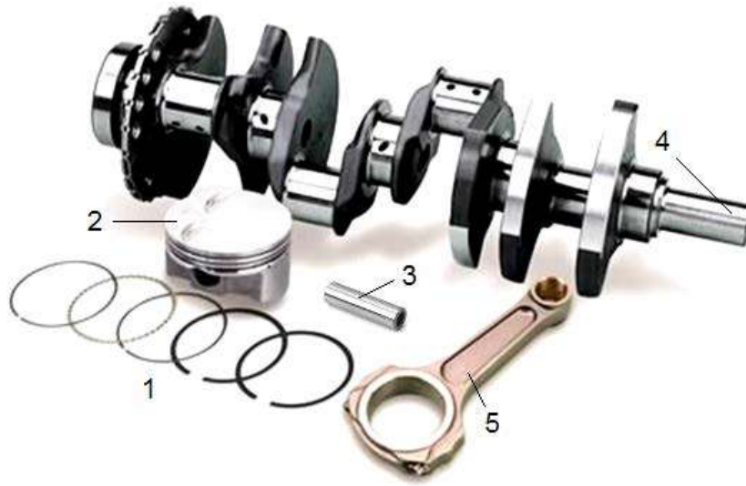
Şəkil 23. Çarxqolu-sürgüqolu mexanizminin tərpənən detalları:
