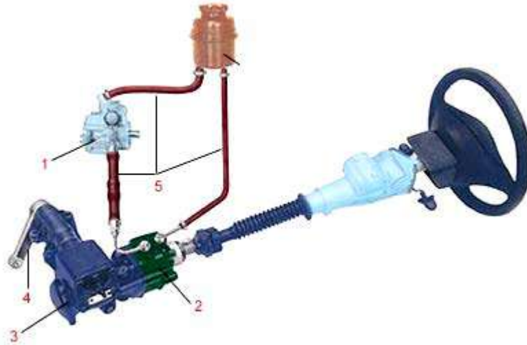
Şəkil 1. Hidravlik gücləndiricili sükan mexanizmi: 1 – nasos; 2 – paylayıcının gövdəsi; 3 – sükan mexanizmi; 4 – sükan soşkası; 5 – birləşdirici şlanqlar; 6 – yağ çəni
